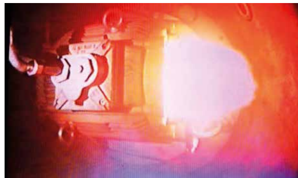
Abbildung 1: Zünddurchschlag an einem Prüfmuster (Quelle: EAH Jena/PTB)
