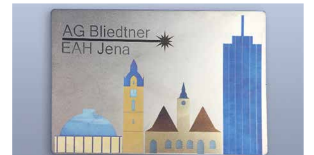
Anlassfarbenmarkierung auf Titan (Foto: EAH/AG Bliedtner)
