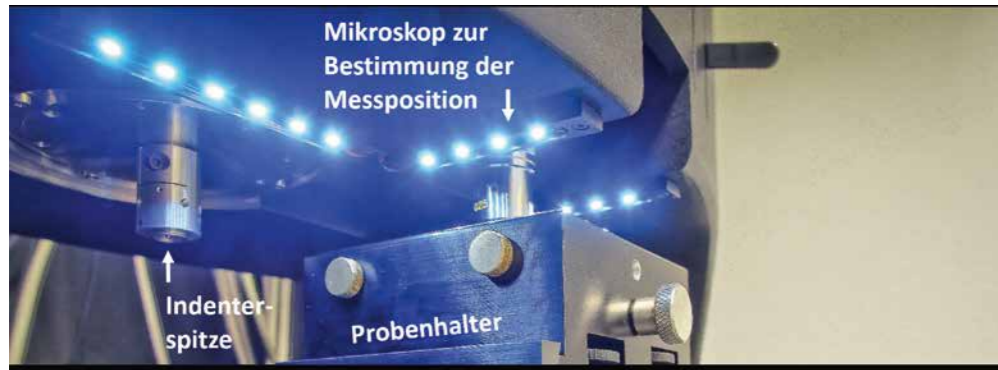
Aufbau des Nanoindenters, Foto: EAH, AG Kunert
