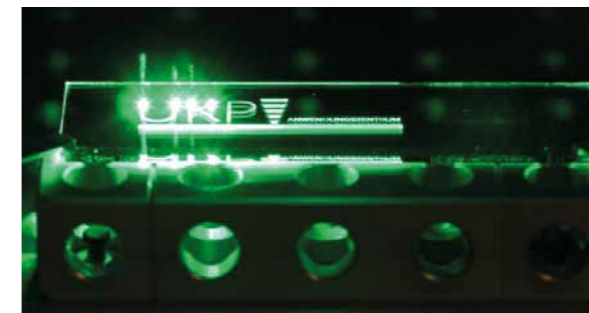
Glasmarkierung mit UKP (Foto: EAH/AG Bliedtner)
