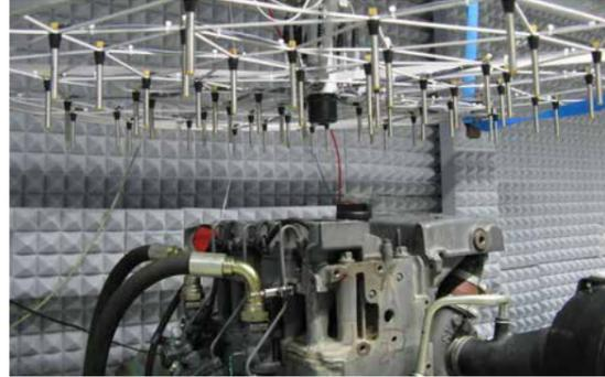
*Akustische Kamera im schallarmen Halbraum über Dieselmotor in Nahfeldanordnung zur Bauteilanalyse, Foto: J.-H. Schwabe*
