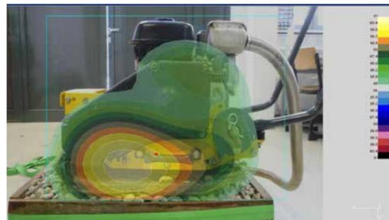
*Schallquellenanalyse an einer Rüttelplatte mit der Akustischen Kamera, Quelle: EAH mit Software PULSE von Brüel&Kjaer*
