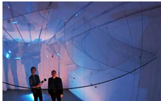
*Hallraum der EAH Jena zur schnellen Ermittlung der Schalleistung und zur Messung von Absorptionsgraden an akustischen Materialien, Foto: J.P. Kasper*
