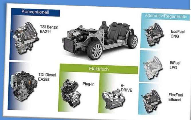
Der MBQ bietet die Möglichkeit verschiedene Antriebsarten in identischer Einbaulage zu integrieren.
