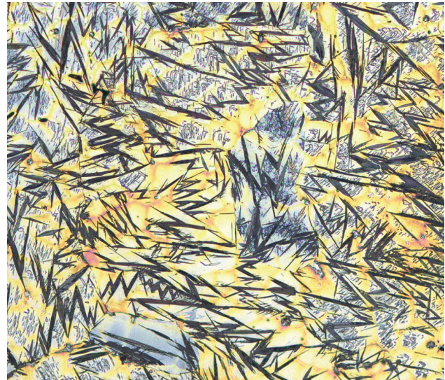
Gefüge eines hochkohlenstoffhaltigen metastabil-austenitischen Stahls
